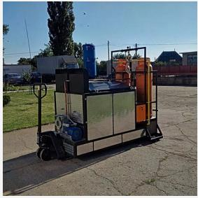
Vedere din spate cu tremocontainerul de incalzire material de adaos si motoreductorul de actionare a snecului pentru deversarea acestuia.
