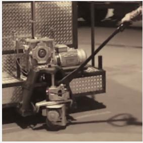
Utilajul poate fi manipulat usor si pozitionat pe amplasament cu un sistem de tip transpalet actionat manual sau cu tractiune electrica
