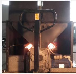
Panou radiant format din arzatoare radiante cu combustie de suprafata, fara flacara, termostatare si modulatie, cu aprindere electronica si sistem de supraveghere a combustiei
